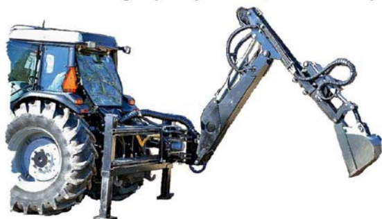
Koparki montowane na ciągniku
