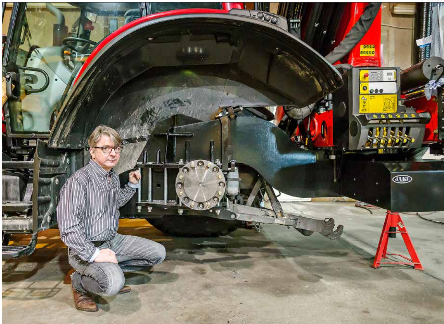
Toimitusjohtaja Jarmo Uusimäki esittelee traktorin tuppisovitetta Tuppisoviteen liitoskohta lukitusmuttereineen on pyörän navan vieressä yläviistossa.
