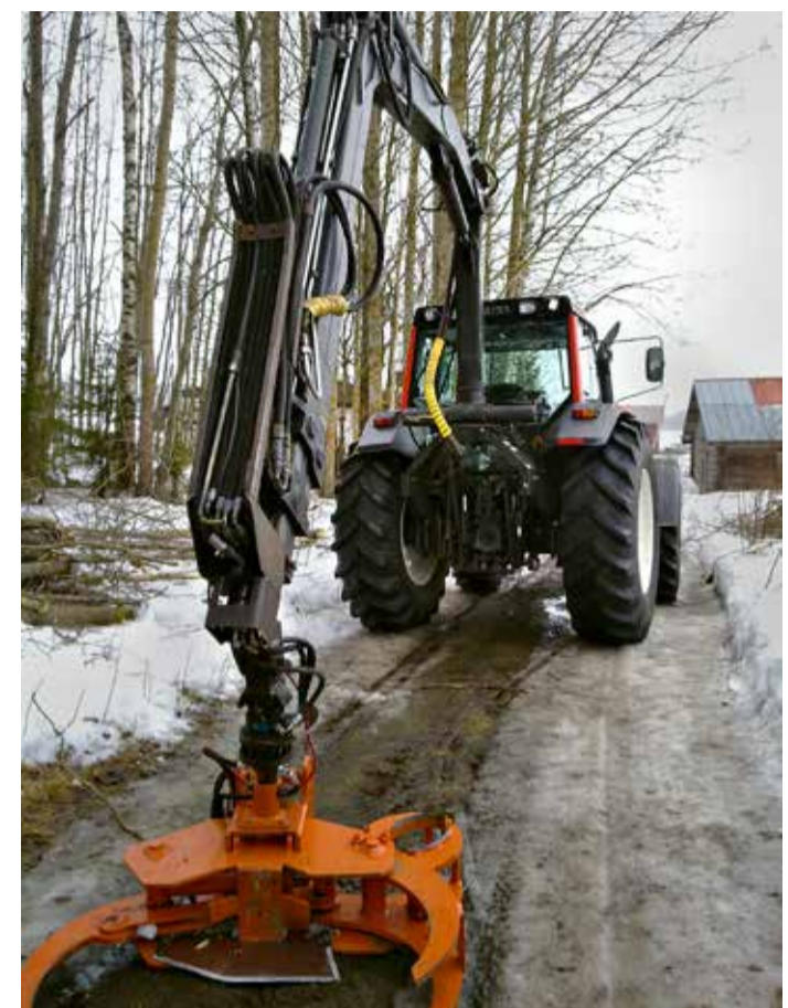
Uusimäen konepajan JAKE-tuppisovite mahdollistaa esimerkiksi energiapuukouran kiinnittämisen traktoriin.
